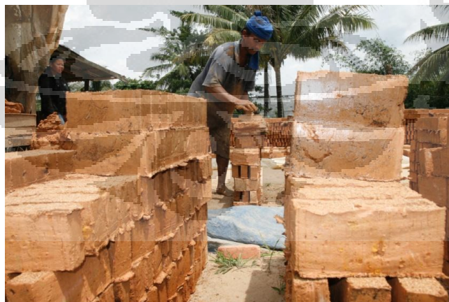
Gambar 2.9. Batu bata setelah melewati proses pencetakan
