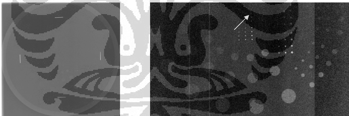
Gambar 4.16. Gambar Hasil Uji Nois dan Resolusi Kontras Rendah Kondisi Eksposi 75 kVp, 1 mR, 1 mmCu
