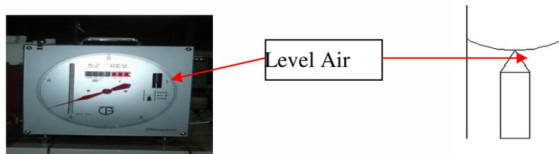
Gambar 3.5 Level air pada Wet Gas Meter [1]
