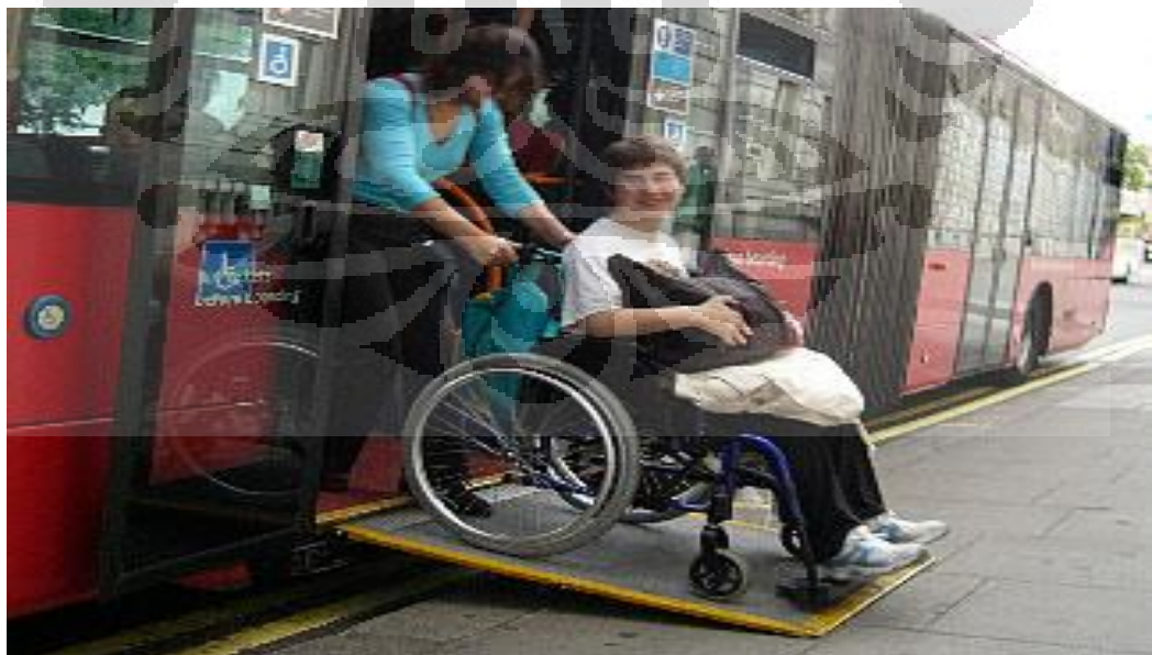
Gambar 3.5 Bus yang dilengkapi dengan pintu akses bagi orang cacat dan orang tua
