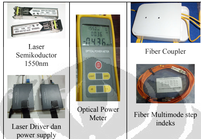
Gambar 4.1 Komponen penyusun system superposisi laser semikonduktor
