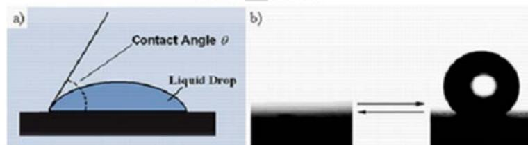
Gambar 2.5. Pengukuran sudut kontak; b contoh umum perubahan antara permukaan superhidrofilik dan superhidrofobik.
