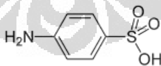
Gambar 2.17 Struktur molekul aniline-4-sulfonate .
