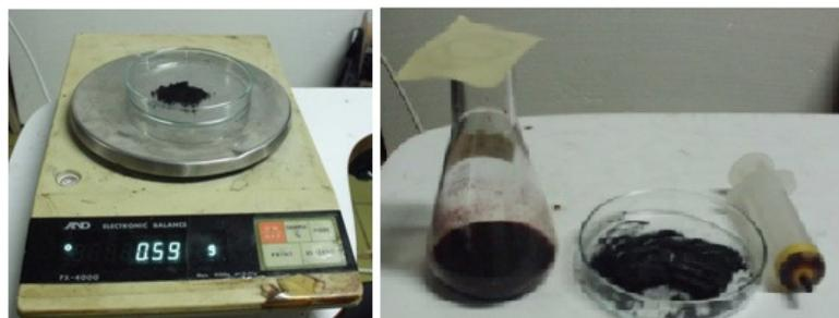
Gambar 3.4. Pencampuran Pengenceran Likuida Lignoselulosa dengan Serbuk Nano Karbon Aktif.
