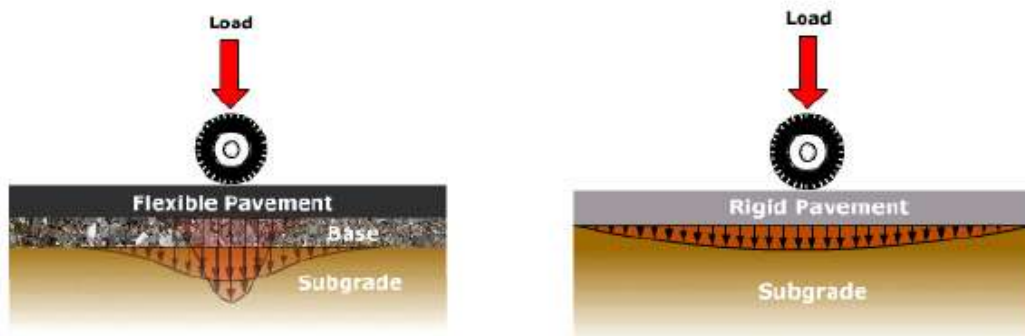
Gambar 2.1 Distribusi Pembebanan Pada Perkerasan Lentur dan Kaku
