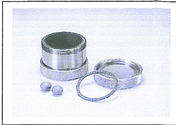
Gambar 2.6 Bola giling dan wadah penggilingan [Suryanarayana,C 2001]
