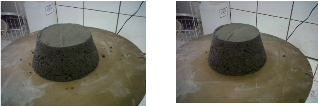
Gambar 4.15. Mortar dengan 2% NaLS fas 0.425 sebelum hentak dan sesudah hentak
