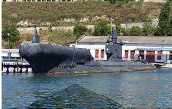
Kapal selam kelas Romeo merupakan kapal selam dengan misil berpemandu (SSG) buatan China. Kapal selam ini memiliki panjang 76,6 meter dengan lebar 6,7 meter dan tinggi 5 meter. Kapal selam dengan mesin disel ini memiliki bobot 1.710 ton dengan kecepatan maksimal 13 knot dan dioperasikan 51 awak. Kapal selam ini dilengkapi dengan 8 torpedo 21 inch dan 14 torpedo yang dapat dilengkapi dengan torpedo Yu-1 atau Yu-4 atau 28 ranjau.
