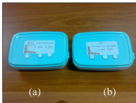
Gambar 3.2 Sampel Ba_{0.5}Sr_{0.5}TiO_3 dengan (a) Sintering 1200°C selama 1, 2 dan 3 jam dan (b) annealing 900°C selama 1, 2 dan 4 jam (Lab. UPPIPD FMIPA UI, 2012)
