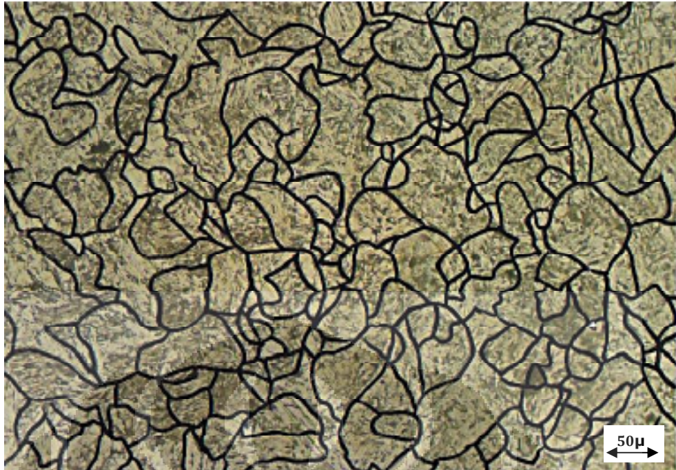
Gambar 4. 8 Foto butir austenit prior pada Baja HSLA 0,111% Nb. Temperatur pemanasan 1200 °C, waktu tahan 20 menit, perbesaran 500x.
