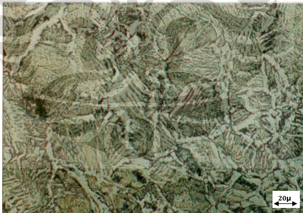
Gambar 4. 5 Foto butir austenit prior pada Baja HSLA 0,111% Nb. Temperatur pemanasan 1100 °C, waktu tahan 20 menit, perbesaran 500x.
