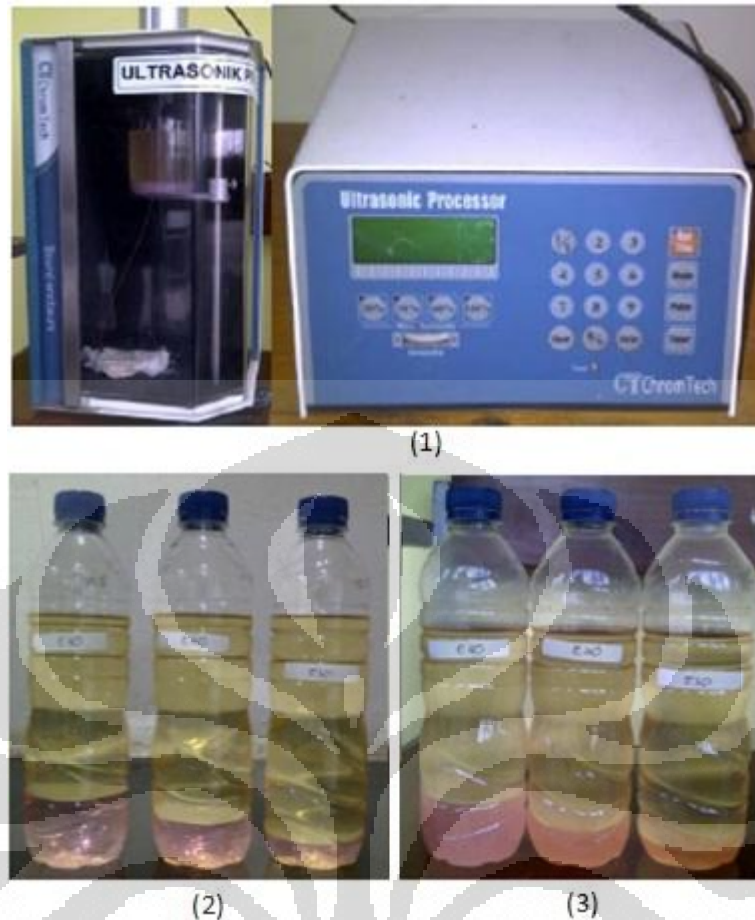
Gambar 3.2. Percobaan pencampuran bioethanol 60% & premium dengan ultrasonic vibration ; (1) ultrasonic vibration ; (2) kondisi sebelum percobaan; (3) kondisi setelah percobaan
