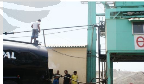
Foto Truk Aspal yg tersambung dg AMP Baita Sari
