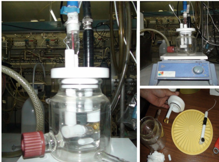
Gambar 3-6. Sel elektrokimia untuk pengujian polarisasi
