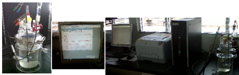
Gambar 3.4: Peralatan uji polarisasi potensiodinamik merk GAMRY
