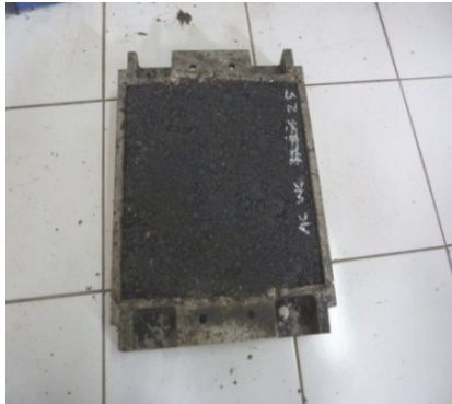
Gambar 3.6. Benda uji dan alat Wheel Tracking . Sumber : Lab Pusjatan Dep.PU
