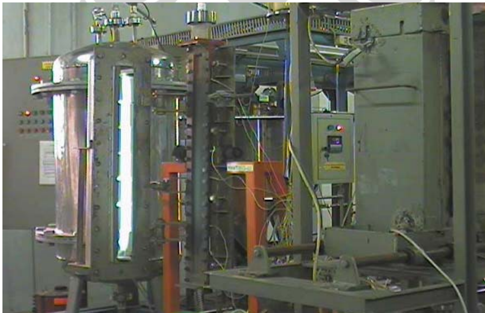
Gambar 4.1. Posisi alat uji celah sempit persegi pada saat di capture dengan kamera infra red
