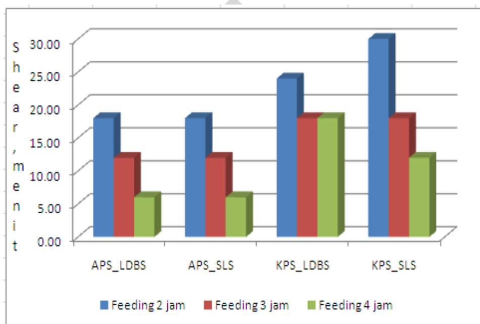
Gambar 19. Grafik hasil pengukuran shear pada berbagai variasi inisiator, surfaktan dan waktu feeding monomer
