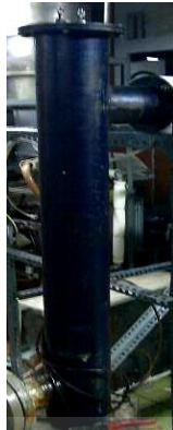
Gambar IIL2 Heater (berada dalam pipa)
