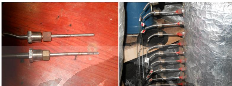
**Gambar 3.10** Termokopel tipe-K dan pemasangannya pada reaktor gasifikasi
