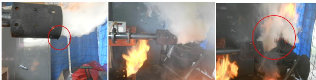
**Gambar 4.6** Indikasi adanya kandungan uap air yang keluar melalui pipa aliran bagian atas
