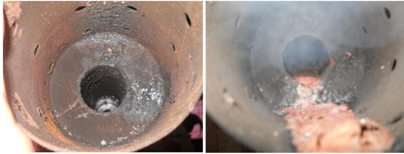
**Gambar 3.11** Kondisi *burner* sebelum dan setelah terjadi eksperimen gasifikasi
