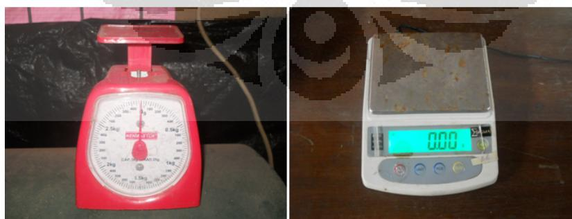
**Gambar 3.8** Timbangan analog dan timbangan digital
