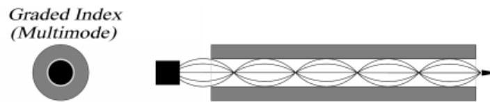
Gambar 2.6 Perambatan Gelombang pada Multimode Graded Indeks
