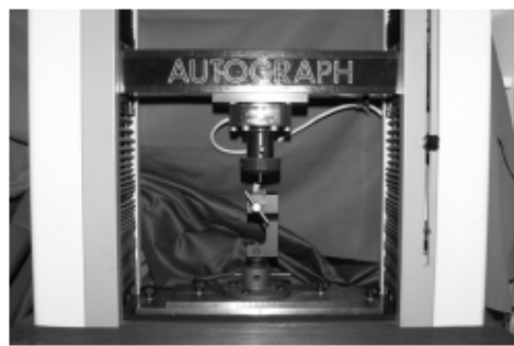
Gambar 2.5 Uji Shear Bond Strength Menggunakan Universal Testing Machine 34
