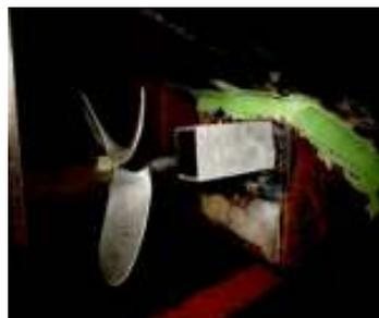
Gambar 3.22. Kapal model dengan *water tunnel* dibuka
