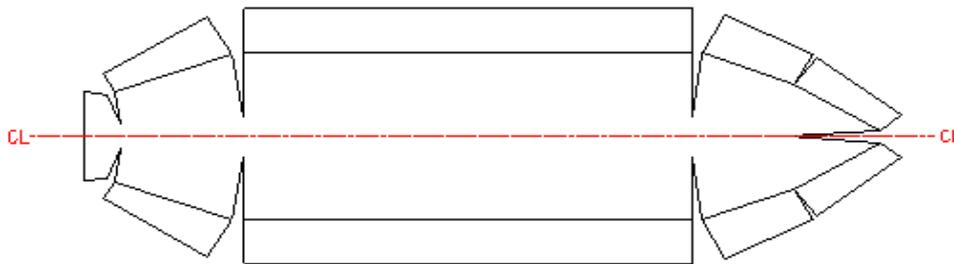
Gambar 3.8. Bukaankulit rancangan kapal menggunakan *software AutoCAD®*
