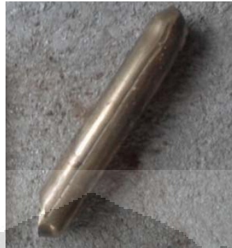
Gambar 4.9. Sampel hasil ECAP dengan sudut 120°.
