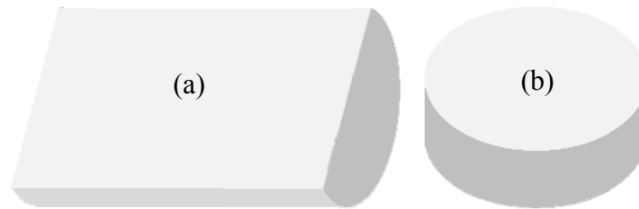
Gambar 3.3. Bagian Benda Uji yang akan Diamati Mikrostrukturnya, (a) memanjang dan (b) melintang.
