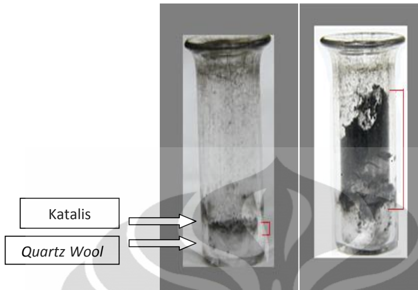
Gambar 4. 8 Wadah katalis dalam reaktor ( holder ) berisi (a) 0,01g fresh catalyst dan (b) produk nano karbon setelah 10 jam direaksikan metana.
