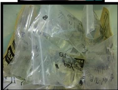
Air sampel yang dimasukkan ke dalam plastik khusus sebelum dilakukan pengujian laboratorium
