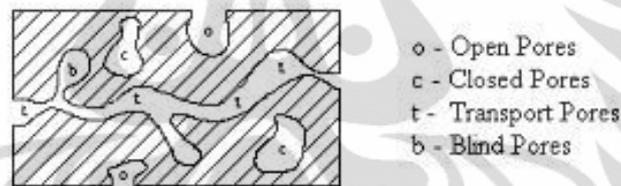
**Gambar 2. 2** Struktur Adsorben Berpori
