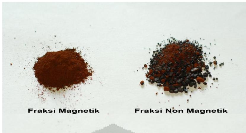
Gambar 4.5 Penampakan Fisik Fraksi Magnetik dan Fraksi Non Magnetik
