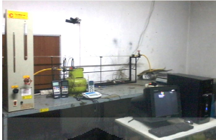
Gambar 3.15 Instalasi pengujian untuk percobaan hubungan laju aliran dengan tekanan keluar regulator
