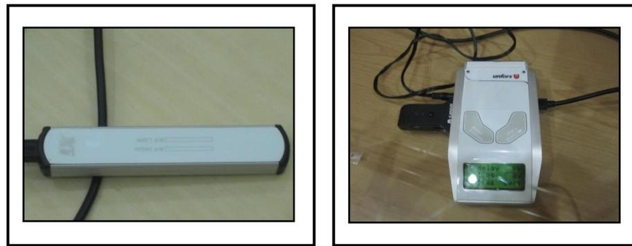
Gambar 3.1 Detektor *Unfors*
