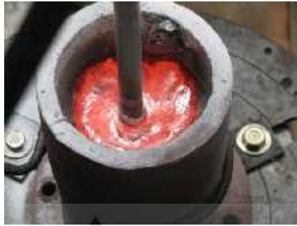
Gambar 3.11 Proses steering cairan aluminium-tembaga sambil melakukan pencampuran partikel alumina secara bertahap.
