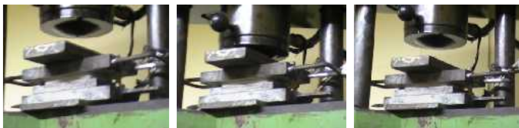
Gambar 3.14 Proses penekanan material semi solid dalam cetakan tertutup. (a) punch bergerak turun. (b) penekanan disertai penahanan 3 detik. (c) punch bergerak naik.
