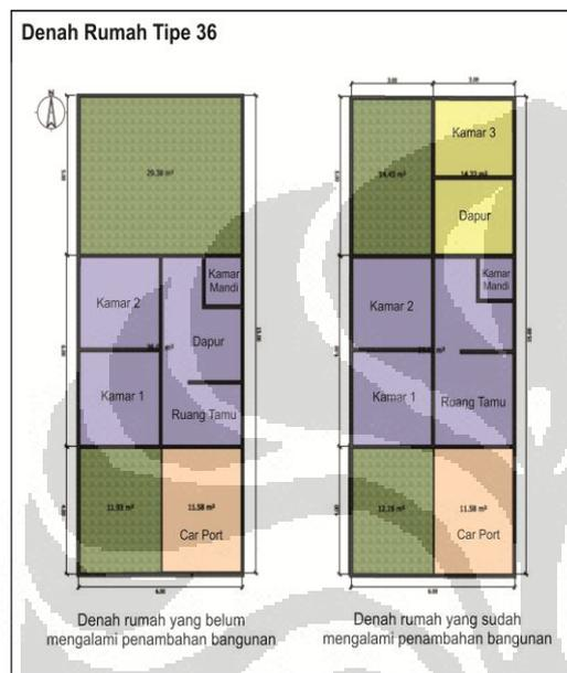
Gambar 3.4 Ilustrasi Denah Rumah Tipe 36 yang mengalami Penambahan Bangunan
