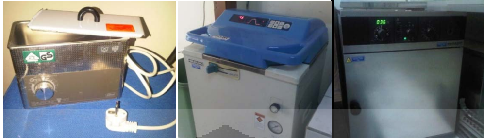
Gambar 8. Ultrasonic cleaning bath merk Transsonic 310, steam autoclave dan inkubator bakteri yang digunakan
