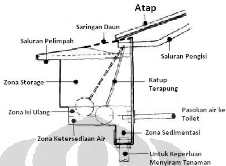
Gambar 2. 5 Detail Komponen Cistern
