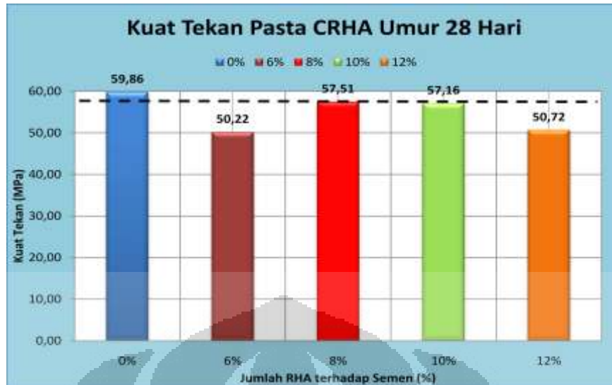
Gambar 2. 3 Grafik histogram hasil penelitian pendahuluan kuat tekan CRHA ( campuran semen + RHA ) pada umur 28 hari
