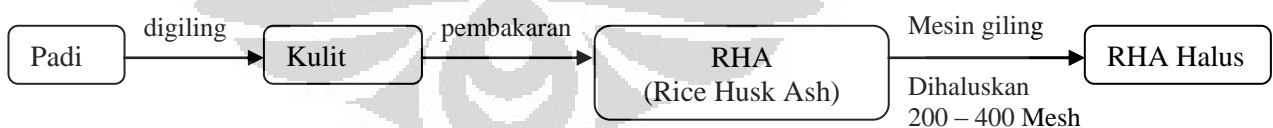
Gambar 2. 2 Keseluruhan proses pembakaran abu sekam padi
