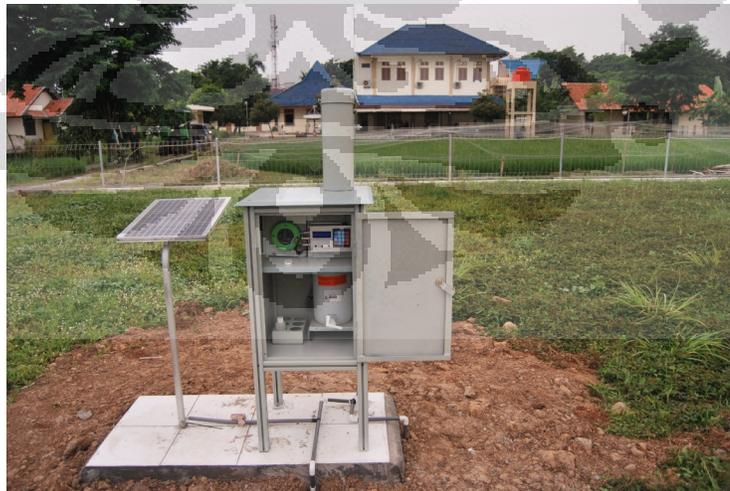
Gambar 2.5. *Automatic Rain Water Sampler* tahun 2010 tipe kedua di taman alat Stasiun Klimatologi Semarang
