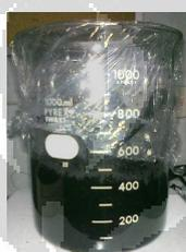
**Gambar 4.4.** Arang Tempurung Kelapa Sawit Setelah Proses Aktivasi Kimia
