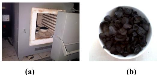
**Gambar 4.2.** (a) Proses Karbonisasi Menggunakan *Furnace* dan (b) Hasil Karbonisasi dari Tempurung Kelapa Sawit
