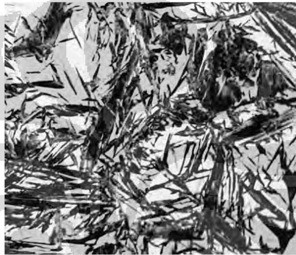
Gambar 2. 9. Foto mikro martensite (berbentuk jarum) pada matriks retained austenite pada bagian berwarna putih [20]
