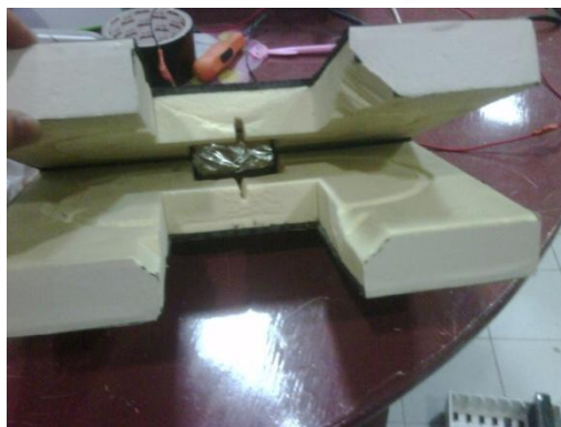
Gambar 3.21 Isolator dengan material polyurethane
