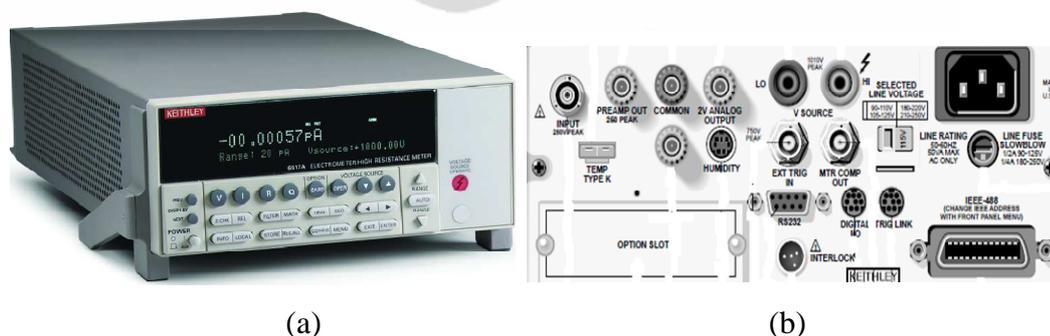
Gambar 3.4. (a) Tampak depan dan (b) tampak belakang elektrometer keithley 6517A[12]
