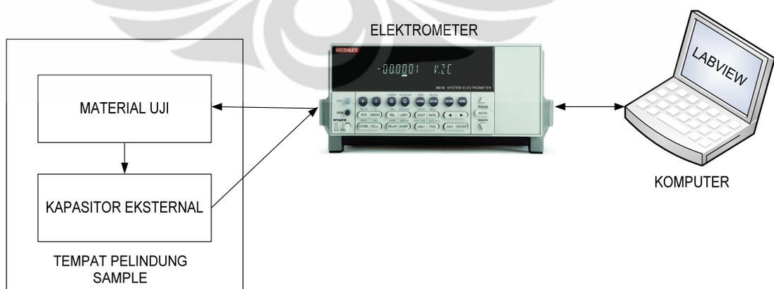
Gambar 3.1. Blok diagram cara kerja alat
