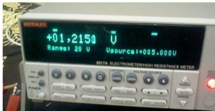
Gambar 4.9. Pembacaan tegangan minus pada elektrometer
