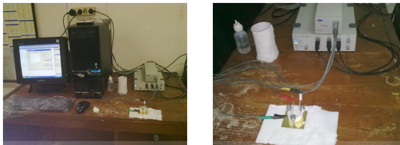
Gambar 2.7 Instrumentasi potensiostat dengan sistem tiga elektroda: elektroda kerja, elektroda pembanding, dan elektroda pendukung
