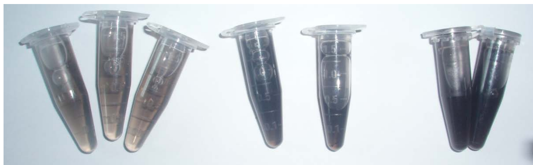
Gambar 3.3 Warna Larutan SWCNT Sebelum Sentrifugasi Pertama(Kanan), Sebelum Sentrifugasi Kedua(Tengah), Setelah Sentrifugasi Kedua(Kiri)
