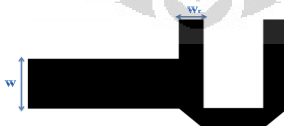
Gambar 3.2 ilustrasi rancangan lebar resonator dan lebar pencatu;
