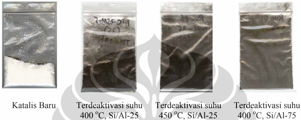
Gambar 4.22 Beberapa Foto Sampel Katalis Baru dan Setelah Uji Reaksi
