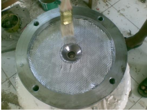
Gambar 3.12. Cetakan lower dilayer dengan serat WR 200
