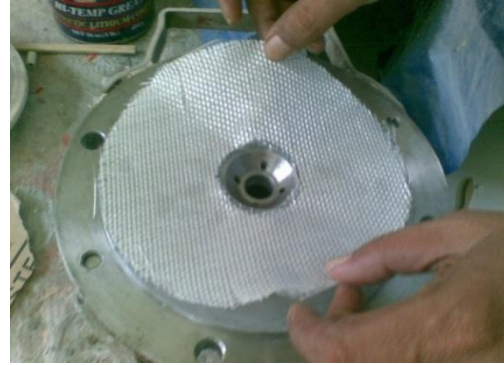
Gambar 3.13. Cetakan upper dilayer dengan serat WR 200
