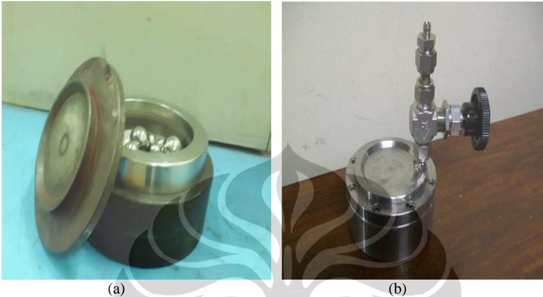
Gambar 3.2. Mangkok miling untuk proses IMA (a) dan RMA (b)
