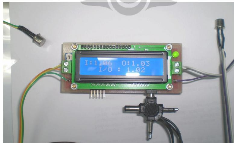
**Gambar 3.31.** Photo gas sensor, mikrokontroler, dan display
